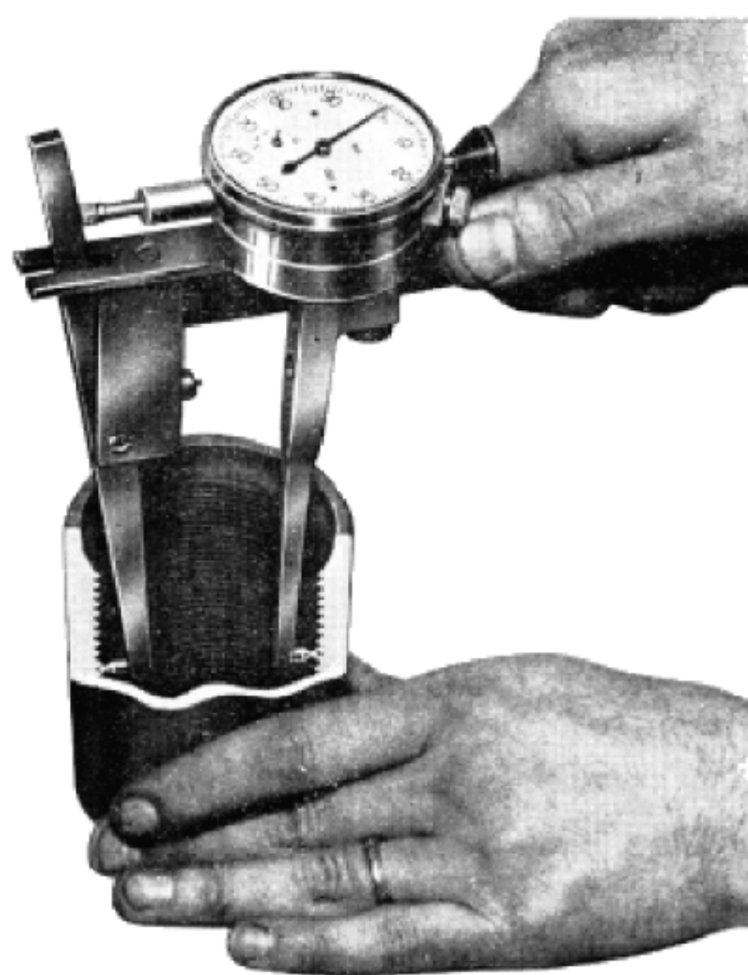
图 12 用于规格小于 4\frac{1}{2} 的典型内螺纹锥度量规
